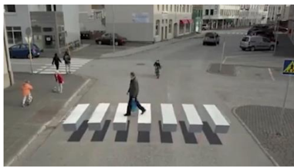
Le strie pedonali tridimensionali. Disegnate sull'asfalto, inducono gli automobilisti a rallentare
