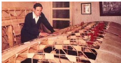
Fedrigoni impegnato a costruire nel salotto di casa le ali del suo aereo
